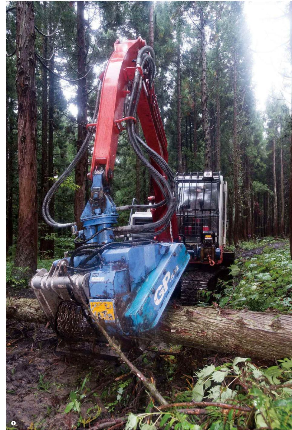
①プロセッサで伐倒した木を造材する。組合ではグラブ2台、フォワーダ2台を所有し、作業の効率化を図る
