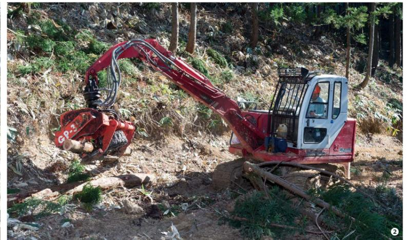
① 伐採した木を丸実自慢のロングリーチグラブがつかんで引っ張り上げる！伸縮式のアームは12メートル先の材をつかむことが可能だ ② ロングリーチグラブで引き上げた材をプロセッサで玉切りし、仕分ける。伐倒→グラブで引き上げ→プロセッサで造材と、作業道から離れた木でも効率の良い流れで生産性を高める ③ 和やかな雰囲気での休憩タイム、チームワークの良さは作業効率はもちろん、安全な作業にもつながっている
