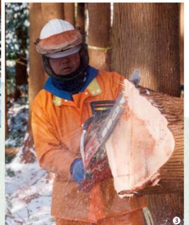
①プロセッサで枝払い・玉切りした材を道の路肩に集積している ②バックホウで伐採後に土の中に残った根を抜いて、地面をならす ③良い丸太にするために伐倒した材の伐り口を平らに成形する ④きれいに整えられた作業道。完成すると750メートルもの距離になる ⑤休憩中は和やかな雰囲気。左から久住さんと高橋さん
